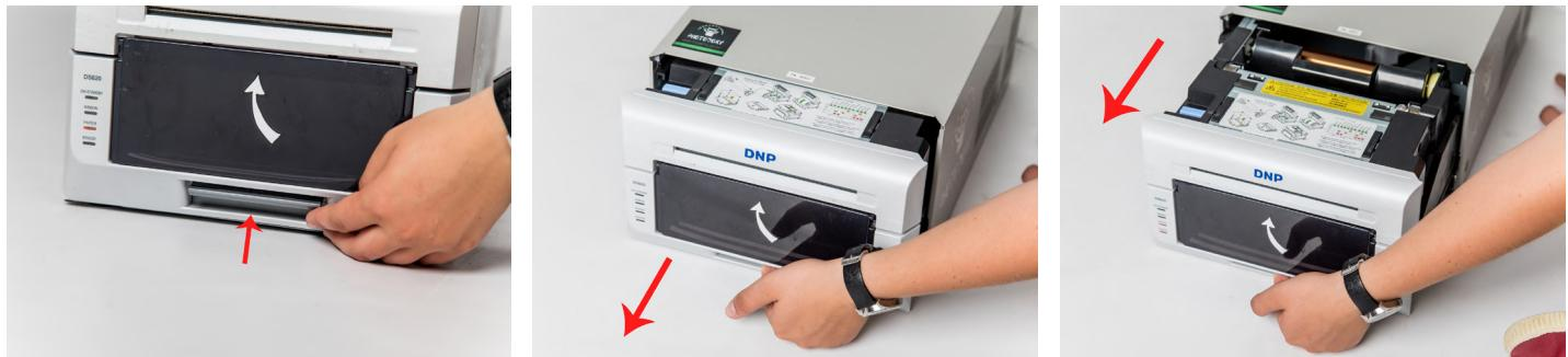
3. Farbband mit Halterung entfernen, Halterung auf Drucker legen und altes Farbband entnehmen sowie entsorgen (Plastik)
