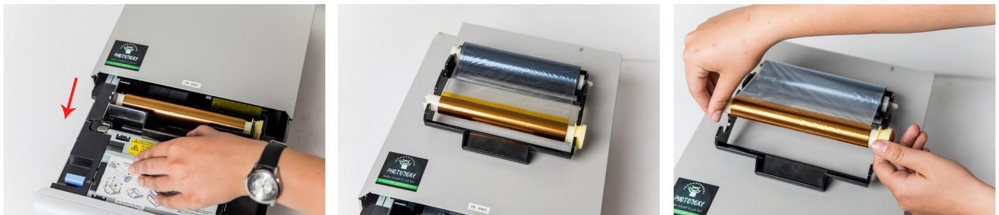
4. neues Farbband auspacken und in Halterung einlegen (an kleinem gelben Nippel orientieren) darauf achten, dass alle 4 Haltepunkte eingerastet sind
